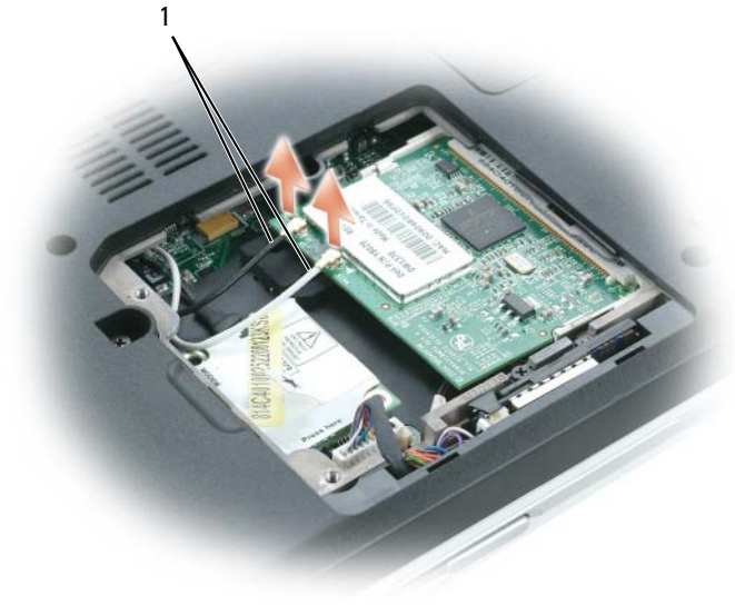
1 Mini PCI antenna cables
